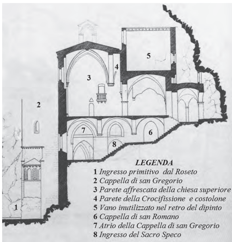
Fig. 2 - Particolare della sezione longitudinale della chiesa superiore.
